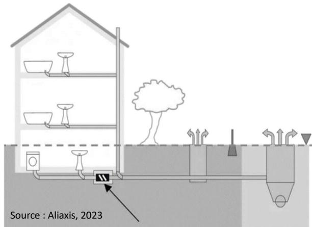
En cas de défaut du propriétaire d'installer et de maintenir en bon état de telles soupapes (clapet antiretour, aussi appelés clapet anti-refoulement), la Municipalité de Sainte-Barbe n'est pas responsable des dommages causés à l'immeuble ou à son contenu par suite des conséquences d'un refoulement des eaux d'égout.
